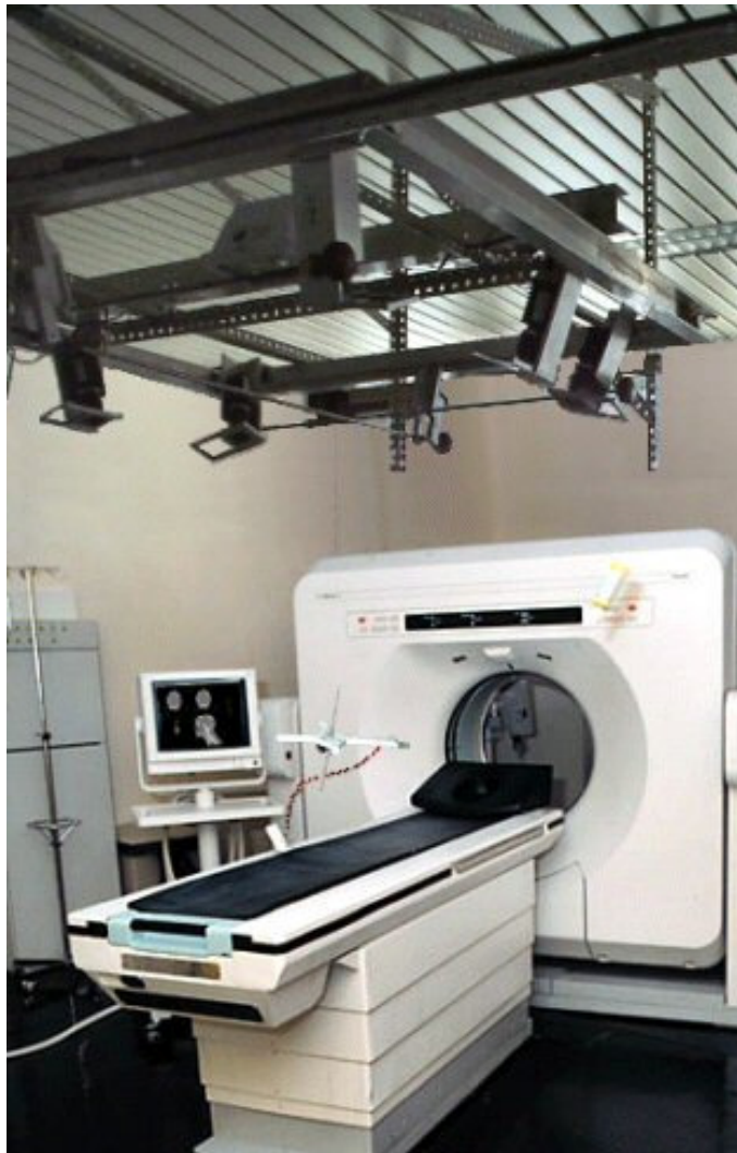
Abbildung 2.3 – Fotografischer Entwurf des Vierkameranystems für den klinischen Einsatz [1]
