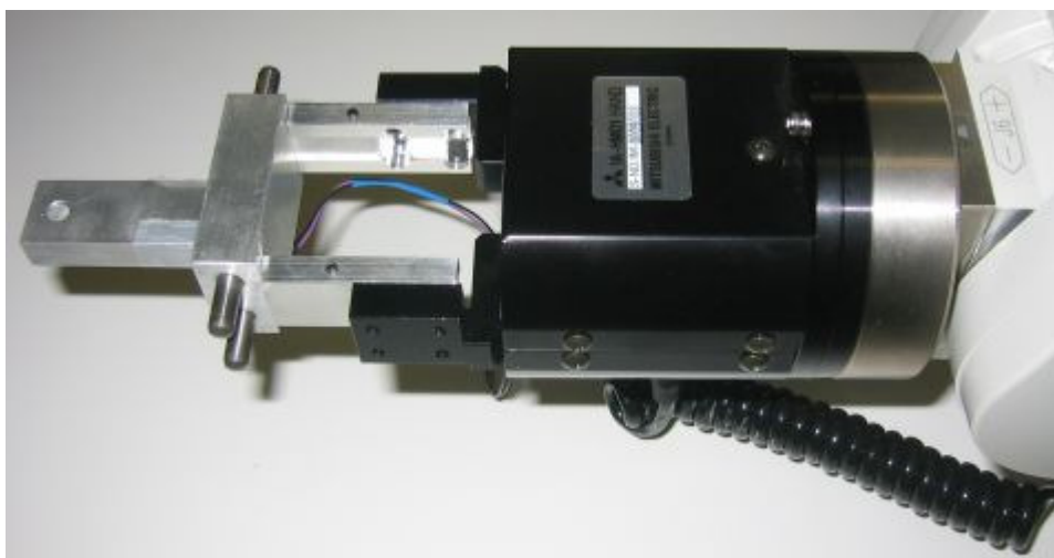
Abbildung 5.9 – Roboter-greifarm mit Halterung und Leuchtdiode
